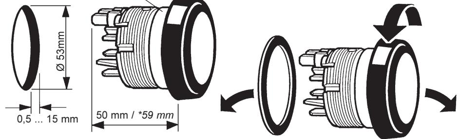
Montieren Sie den Anzeiger mit Bolzen und Bügel (Bestell-Nr. N05 800 766 / \*N05 800 696), wenn starke Schwingungsbeanspruchung am Einbauort zu erwarten ist (z.B. bei Hochgeschwindigkeitsbooten).
