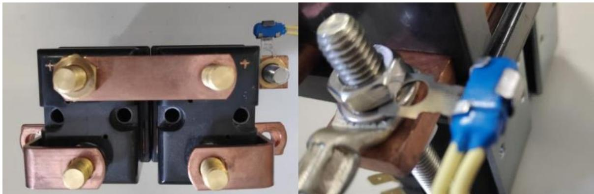
5. Collegare i due fili gialli della sonda di temperatura alla centralina.
